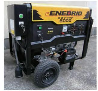
LPガス(プロパン)とガソリンの両方の燃料を使用できるハイブリッド型発電機。50kg容器1本で約33時間の連続運転(4kw負荷時)が可能で、外部からの遠隔操作や自動運転にも対応。
